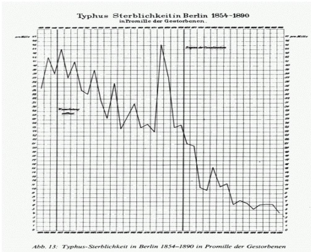
Abb. 2: Typhus-Sterblichkeit in Berlin 1854-1890 in Promille der Gestorbenen. Die erste horizontale Linie zeigt die Eröffnung der Wasserleitung 1857, die zweite den Beginn der Kanalisation 1876. Der Rückgang der Sterblichkeit erfolgte lange Zeit vor Einführung moderner medizinischer Maßnahmen in der Folge von Wasserleitungsbau und Kanalisation. (Quelle: M. Rodenstein: Mehr Licht, mehr Luft . Frankfurt 1988)
